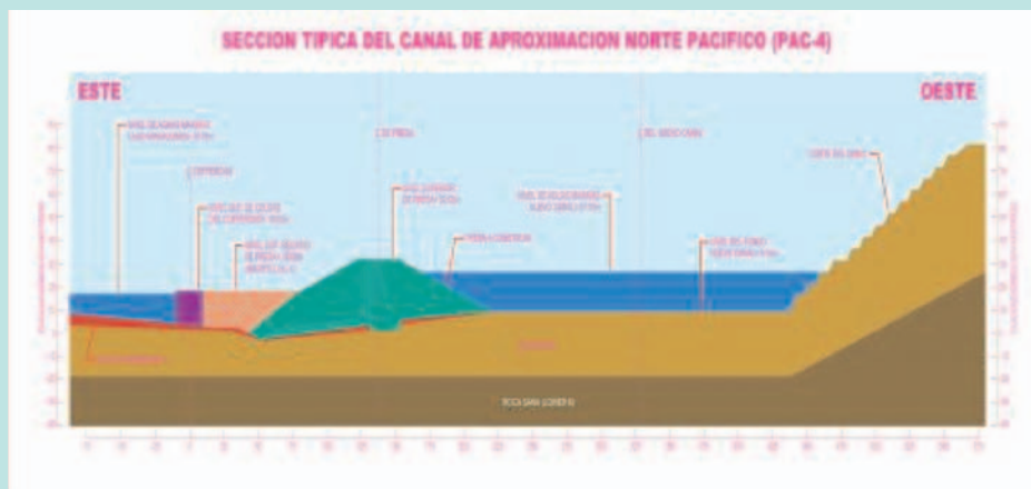
Fig. 27. Presa de Borinquen 1E (PAC-4). Sección explicativa con el nuevo Canal del Pacífico y la presa que lo conduce y separa del Lago de Miraflores.
