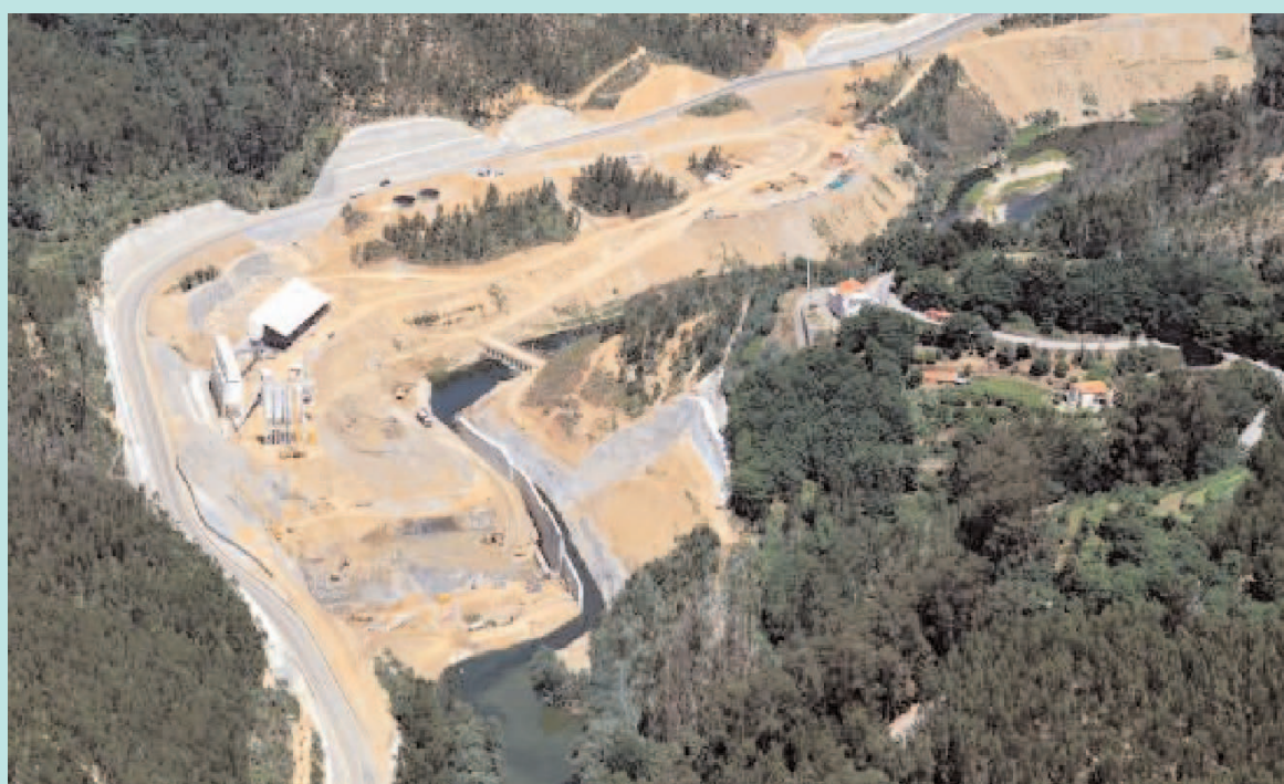
Fig. 23. Presa de Ermida. Vista aérea del desvío, plataforma de instalaciones y accesos.
