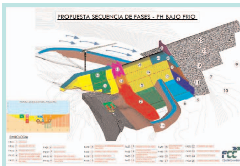
Fig. 25. Presa de La Potra (Bajo Frío). Fases de ejecución de la presa mixta.
